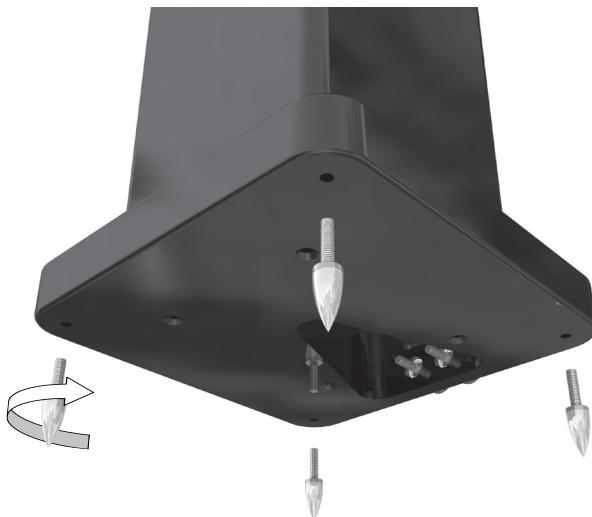
Шипы вкручиваются в свободившиеся отверстия по часовой стрелке. Убедитесь, что шипы вкручены полностью, поднимите колонку и установите её на предназначенное для неё место. Убедитесь, что колонка стоит ровно (если нет, отрегулируйте соответствующим образом шипы, а затем затяните стопорную гайку, чтобы зафиксировать шипы в нужном положении).
