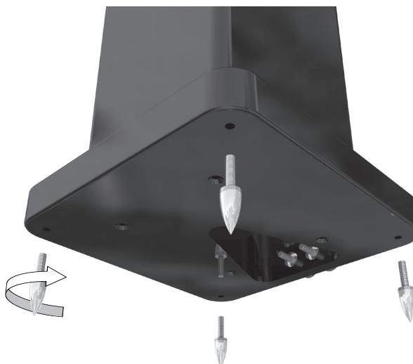
Pegue no espiões e enroque-os para a direita em relação aos socos. Certifique-se de que estão completamente inseridos, endireite-os e coloque-os na sua posição definitiva. Para nivelá-los, ajuste os espiões em conformidade, antes de apertar finalmente a porca de segurança serrilhada para manter os espiões nessa posição.
