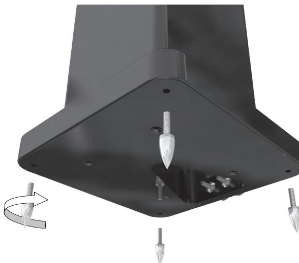
Para insertar las puntas en los plintos/la base, gírelas en el sentido de las agujas del reloj. Asegúrese de que están completamente insertadas, ponga la caja de pie y colóquela en su posición definitiva. Para nivelarla, ajuste convenientemente las puntas y, por último, apriete la contratuerca moleteada para fijar las puntas en esa posición.
