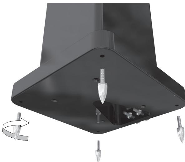
Prenez les pointes et faites-les tourner dans le sens des aiguilles d'une montre dans le socle. Vérifiez qu'elles sont bien insérées, relevez le boîtier et installez-le à son emplacement final. Pour ajuster le niveau, réglez les pointes en conséquence avant de finalement serrer l'écrou de verrouillage moleté pour maintenir les pointes dans cette position.
